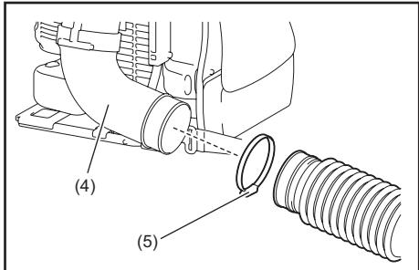
2. Подсоедините гибкий трубопровод к колену (4) на ранцевом распылителе.
