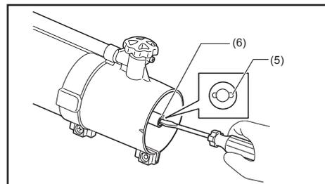
3. Установите форсунку с другим диаметром отверстия.
