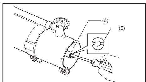
3. Установите форсунку с другим диаметром отверстия.
