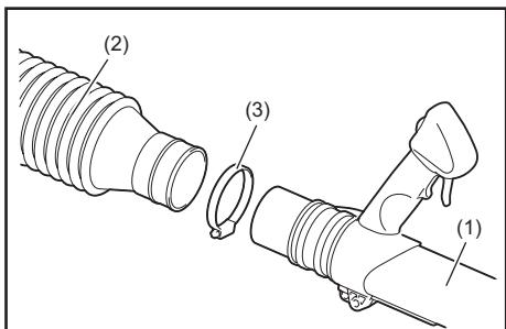
1. Соберите трубу с шарнирным соединением (1) и гибким трубопроводом (2).
