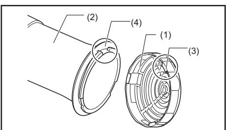
Чтобы установить дисперсионную крышку (1), поместите ее на верхнюю форсунку (2) таким образом, чтобы совместить ее выступ (3) с выемкой (4) в верхней форсунке.
