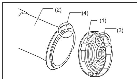
Полностью поверните дисперсионную крышку по часовой стрелке, чтобы зафиксировать ее.
