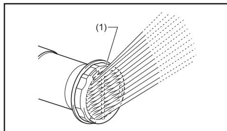
Для установки дефлектора (1) установите его на верхнюю форсунку так, чтобы отметка «I» (3) на дефлекторе совпала с отметкой «I» (4) на верхней форсунке (2).
