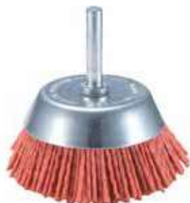
ЩЕТКИ ЧАШЕЧНЫЕ служат для подготовки поверхности к покраске, удаления ржавчины, старой краски, окалины, загрязнений, матовой отделки и искусственного старения древесины.
