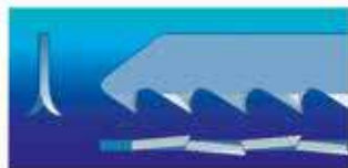
фрезерованные разведенные зубья
