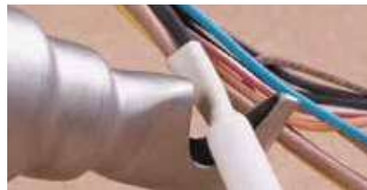
Монтаж термоусадочных трубок (только HG651C)
