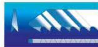
фрезерованные заточенные зубья
